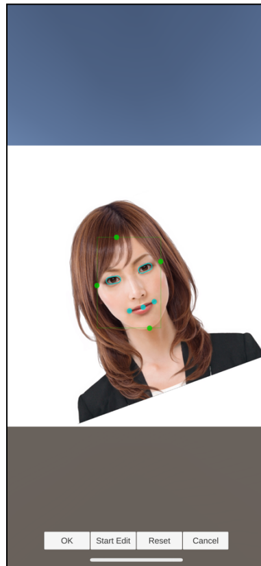
図3-11:入力画像に図3-10を用いたときの(1)確認画面。 表示されている特徴点は、図3-10の画像から自動検出で得られたものである。
