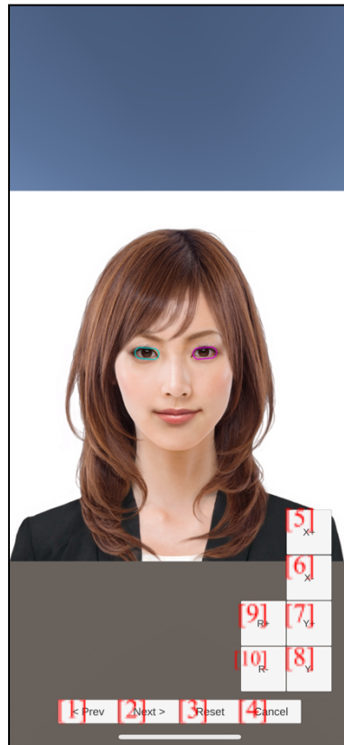
図3-7: 目の編集画面。 右側の矩形が選択状態になっている。 GUI部品に[1]～[10]の番号を付記している。
